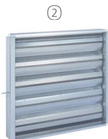
Isolierte Jalousieklappe mit Federrücklaufmotor, 24 V, stromlos öffnend, montiert auf der Saugseite des Gerätes.
